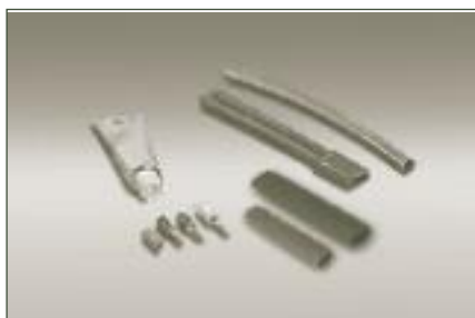
PETK-1 Наборы концевой заделки для взрывоопасных и промышленных областей. Заделывает нагревательные кабели SX в соединительных коробках. Набор включает соединительную гильзу, оконцовку, силиконовый клей, ПВХ желто-зеленую трубку и необходимые наконечники. KSR - SK-DB . . . Набор сращивания для взрывоопасных и обычных областей.
