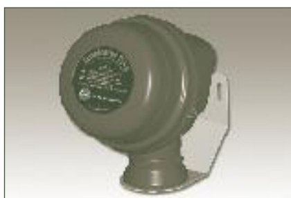
Terminator ZP-WP ...соединительная коробка для подключения нагревательных кабелей к питанию, разработана использования в обычных и взрывоопасных зонах и имеет степень защиты IP66.
