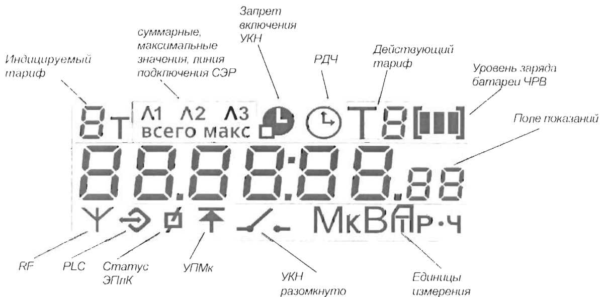
Рисунок Д.1 – Расположение полей дисплея счетчика
